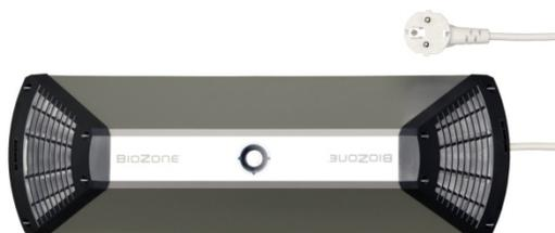
A manutenção do BioZone é simples. A única peça que necessita de manutenção/substituição é a lâmpada UV. Se a unidade é utilizada ininterruptamente, a lâmpada deverá ser substituída uma vez por ano. Se a unidade é utilizada de vez em quando a lâmpada funcionará durante 2-3 anos dependendo do nível impuridades no local.
